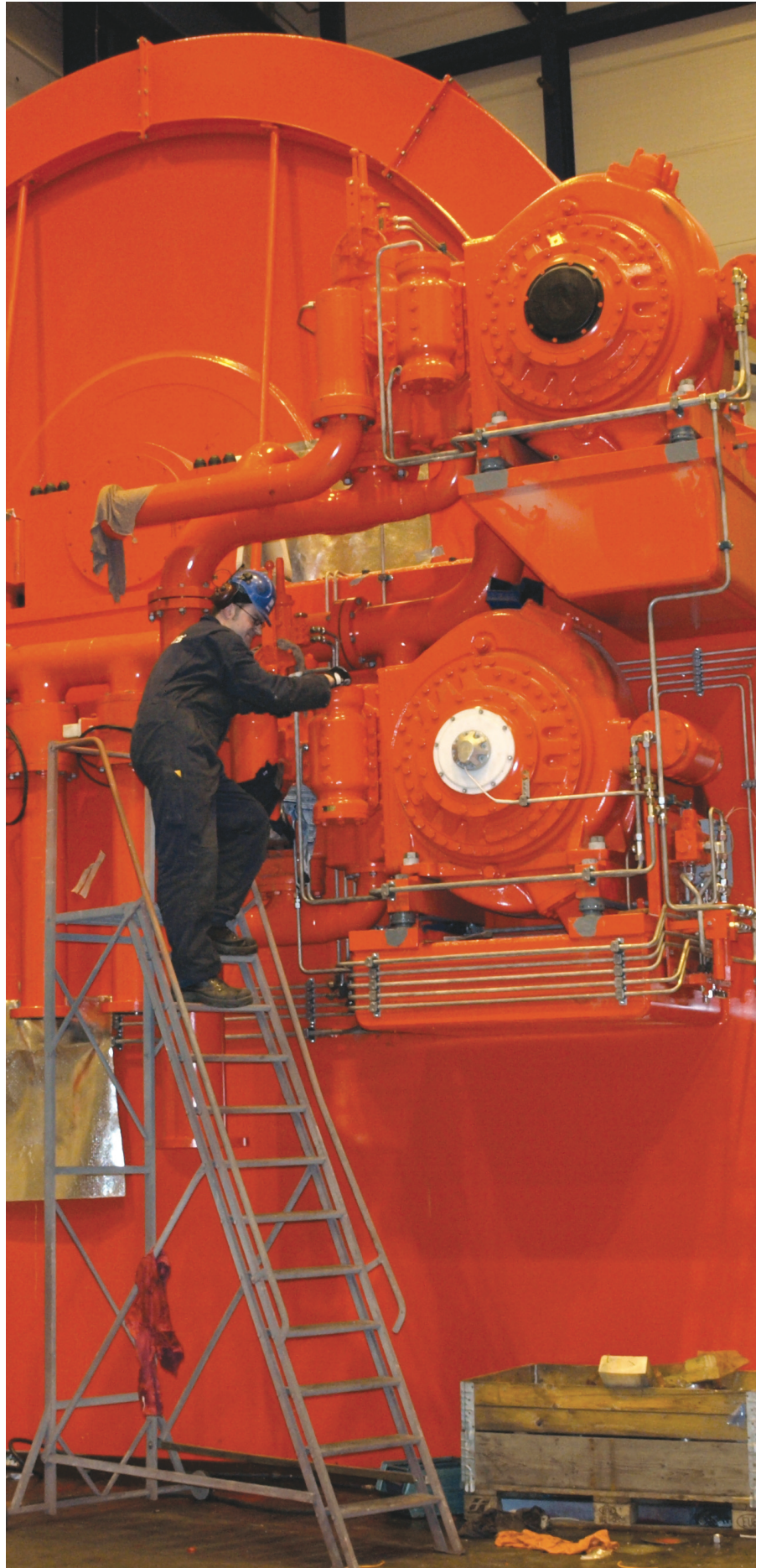
En vinsj med trekkraft på 600 tonn som blir brukt ombord i et ankerhåndteringsfarty. (illustrasjonsfoto RR)
